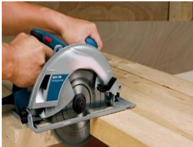
Gambar 3: Memotong Kayu Menggunakan Gergaji Listrik (Sumber : www.konstruksikayu.blogspot.com )
