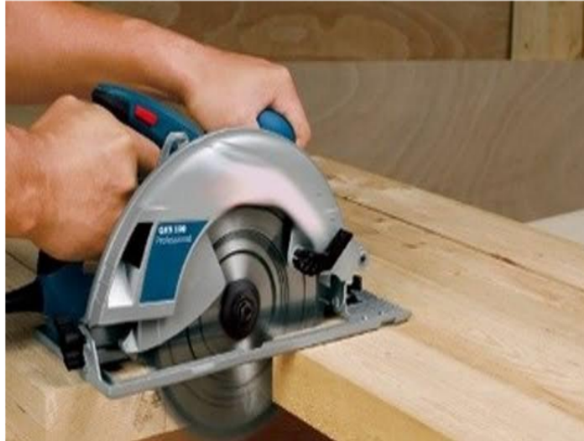
Gambar 3.1 Memotong Kayu Menggunakan Gergaji Listrik
