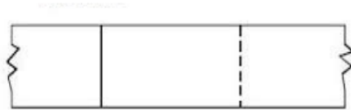
Gambar 2 : Garis Gambar Pada Sambungan Tampak Atas
