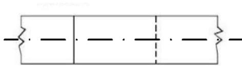
Gambar : contoh penerapan garis setrip titik pada sebuah garis bambar
