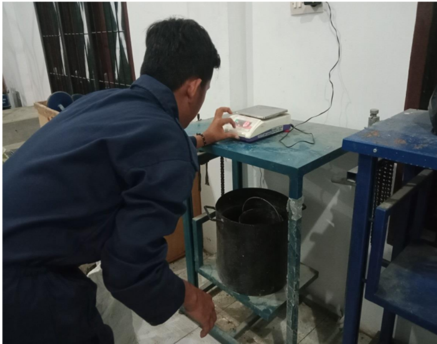
Penimbangan agregat didalam air untuk mencari berat jenis agregat kasar.
