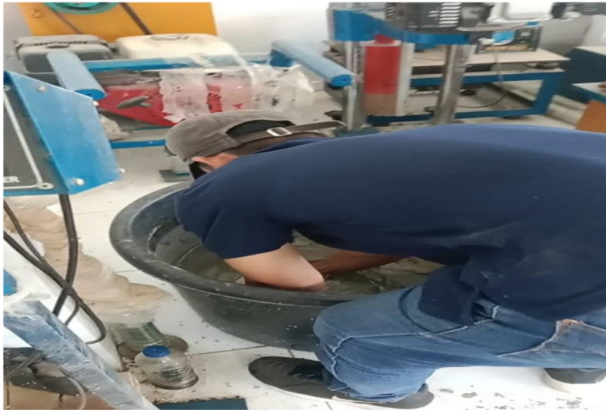
Proses perendaman beton.
