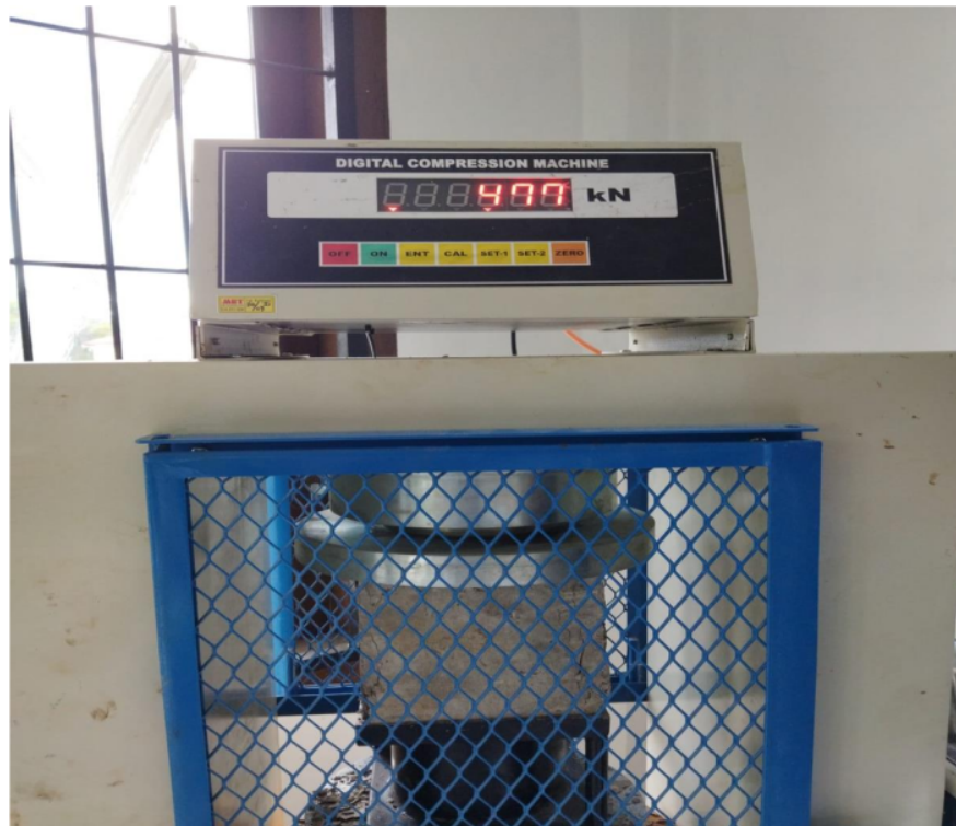
Proses pengujian kuat tekan beton.
