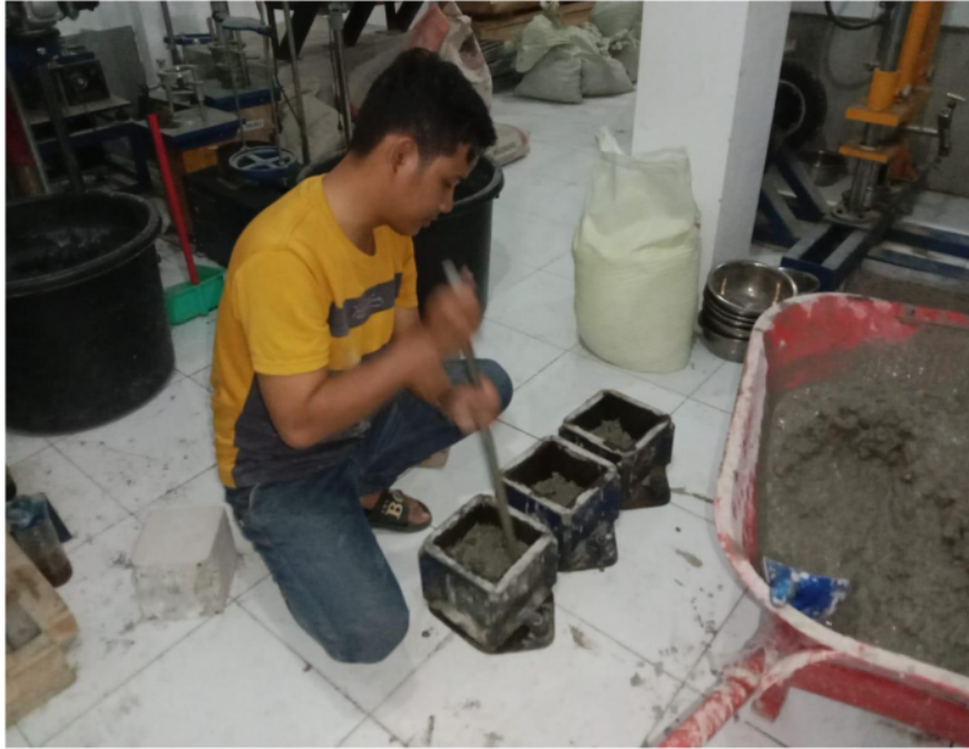
Proses pencetakan beton dalam cetakan kubus.
