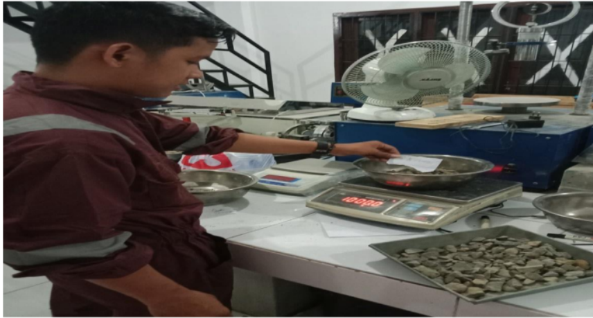
Penimbangan benda uji agregat halus dan kasar untuk pemeriksaan kadar air.
