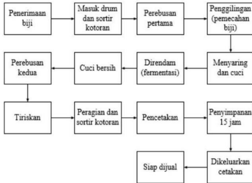
Gambar 2.1 Proses Pengolahan Tempe
